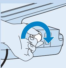
**8** Завинтете добре капачето за промиване на системата за почистване на накип към парния резервоар.
