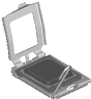
2. 寻找CPU上的两个定位口，使定位口与CPU插槽的两个定位口一一对应并且方向正确，CPU才能轻松放入。
