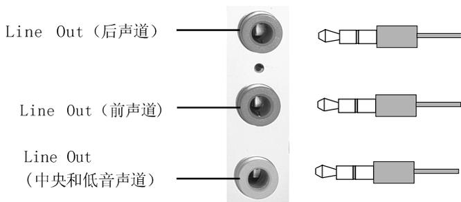
描述：在6声道设置下Line In和MIC被转换成Line Out功能。
