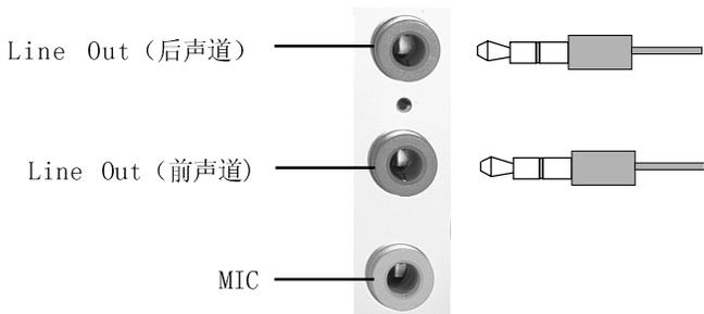
描述：在4声道设置下Line In被转换成Line Out功能。
