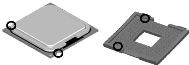
3. 将CPU插入稳固后，盖上CPU座的盖板，压入拉杆至最底部完成安装。
