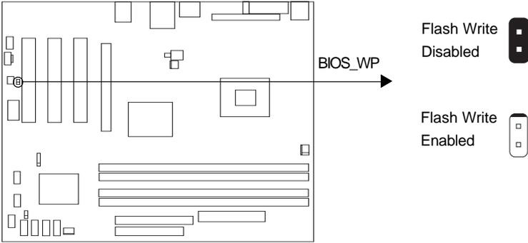
CPU类型与速度,内存容量及扩展卡等DMI(桌式管理界面)系统信息会由板上BIOS检测并保存到Flash ROM中。当硬件配置改变时, BIOS\_WP 只有在打开状态时,DMI 信息才会自动更新,而BIOS\_WP 关闭时, DMI 信息无法更新。
