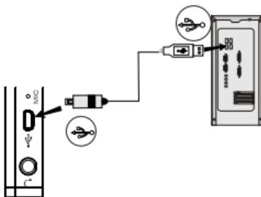
本机采用锂离子电池供电。任何时候，用USB传输线连接本机到电脑，均会自动开机开始充电，充满之后自动停止充电。
