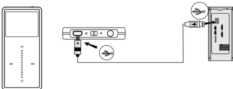
本机采用锂离子电池供电。任何时候，用USB传输线连接本机到电脑，均会自动开机开始充电，充满之后自动停止充电。
