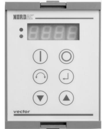
随着参数盒的插入与电源的接通, 4 位 7 段显示器显示出水平的破折号。表明变频器的操作准备就绪。如果变频器转换为激活状态, 通过选取参数 > Selection Display Value (选择显示值) < P001(默认值=当前频率), 则显示就自动变为运行值。通过显示器左边的 2 个二进制 LED, 可显示当前的参数设置。
