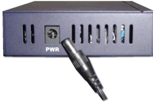
图 3.3 连接电源示意图
