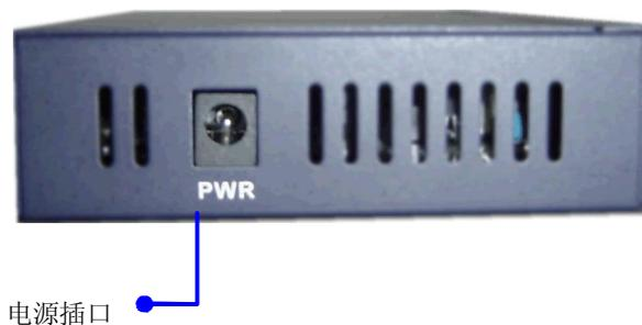
图 2.2 Netcore 2305 NR 宽带路由器侧面板示意图
