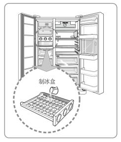
■ 旋转制冰室内的冰块分离旋钮,冰块就 会落入储冰盒中。
