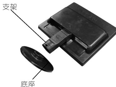
4. 如右图所示将底座闩锁拧为垂直方向锁住底座。
