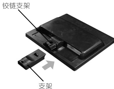
3. 将底座（前面,背面）按正确方向装入支架。
