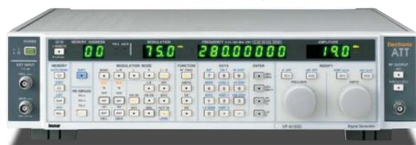
FMステレオに加え、AF信号源としてDDS信号を搭載。周波数特性測定に有効です。
