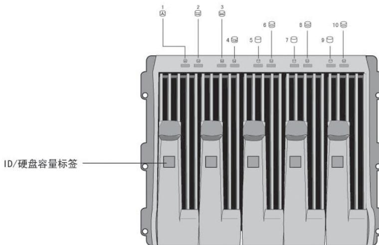
图 2-4 SCSI 模组前面板示意图
