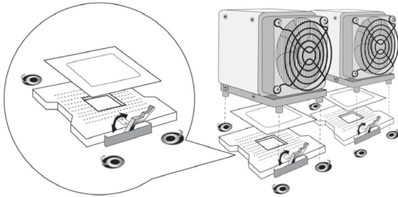
图 2-13 CPU 及散热片的拆装
