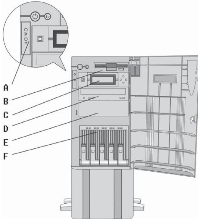
图 2-2 热插拔配置服务器前面板示意图
