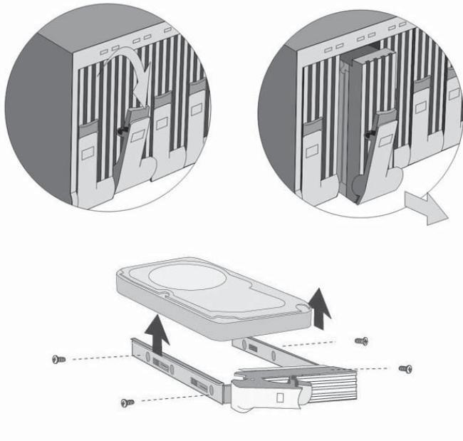
图 2-9 热插拔配置服务器硬盘拆装
