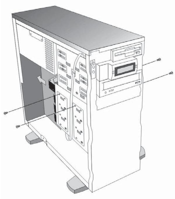
图 2-8 非热插拔配置服务器硬盘拆装
