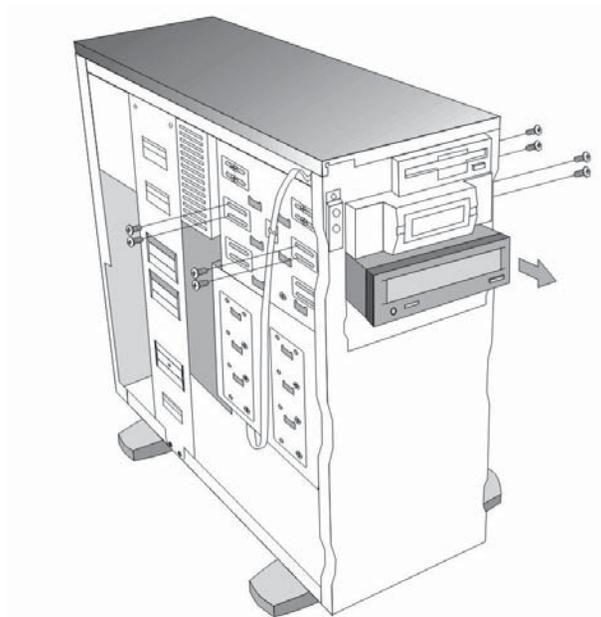
图 2-10 5.25 英寸设备的拆装
