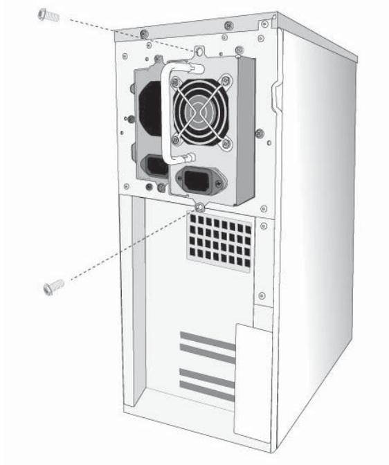
图 2-14 1+1 冗余电源的拆装
