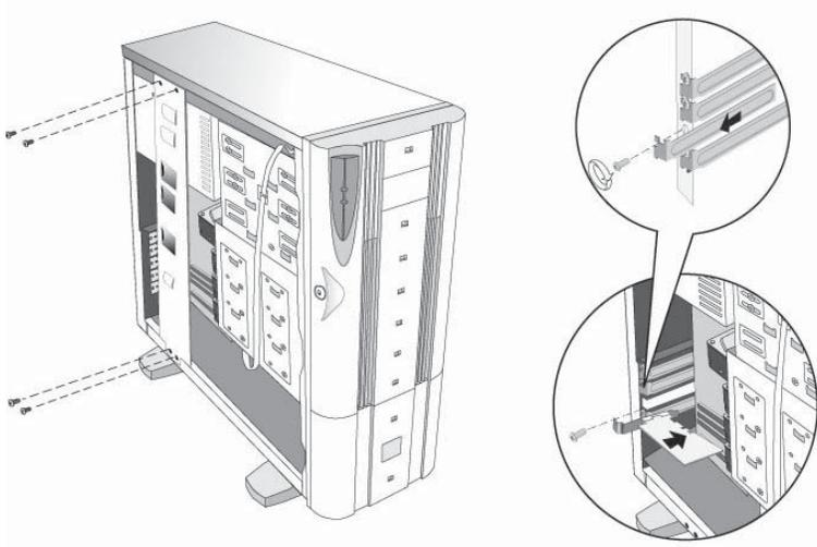
图 2-11 外插卡的拆装
