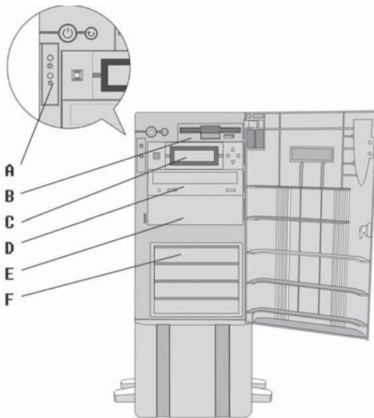
图 2-1 非热插拔配置服务器前面板示意图
