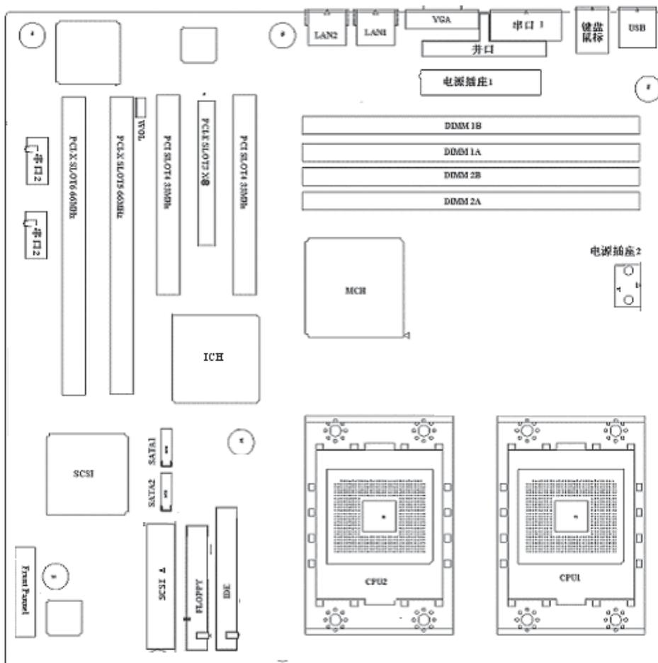
图 4-1 主板结构示意图
