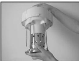
取拉法尔网按安装指示箭头方向装好，拉法尔网口部与机头配合处应紧密无缝隙，安装完毕后，手向下拉一下，拉法尔网不动说明安装到位。
