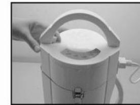
8.请注意提手内侧有自锁开关，若放下提手，请按下开关，放倒即可。
