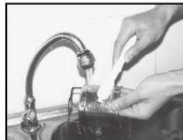
2、网罩：请用清洁刷仔细清洗网罩，注意一定要将侧网与底网用清水冲洗干净，以免残留豆浆干结糊住网孔，影响出浆效果。
