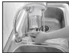
4、电热器、防溢电极和温度传感器请及时清洗干净。
