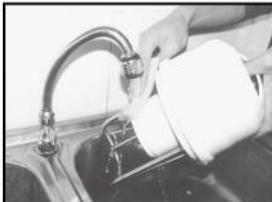
1、机头：请用水轻轻冲去机头下部粘附的豆浆，切勿将机头浸入水中，也不要用水清洗机头上部，以防机内进水，发生短路现象。
