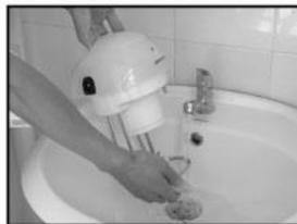
5. 电热器、防溢电极和温度传感器请及时清洗干净。
