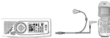
CONNECT "CELLULAR EAR MICROPHONE" ONTO EXTERNAL MICROPHONE ON THE SET AND EARPHONE JACK ON THE MOBILE PHONE.
