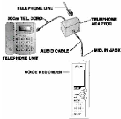
CONNECT LINE-IN CABLE TO THE MICROPHONE JACK ON THE VOICE RECORDER AND TELEPHONE ADAPTOR. CONNECT TELEPHONE CABLE TO TELEPHONE ADAPTOR.
