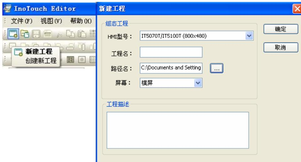
编写工程名称，选择保存工程的路径，选择 HMI 型号以及屏幕类型等，设置完之后，再按下“确定”键后，将会弹出如下对话框：
