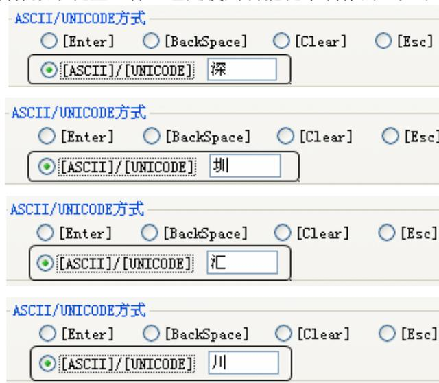
经过上面的步骤，制作了“深”“圳”“汇”“川”这四个汉字输入功能键，再制作一个“Enter”输入功能键，即做好了简单的汉字键盘。在放置一个“字符输入”控件在画面上，字数选为 4，并勾选“使用 UNICODE”，最后做好的画面如下图所示。
