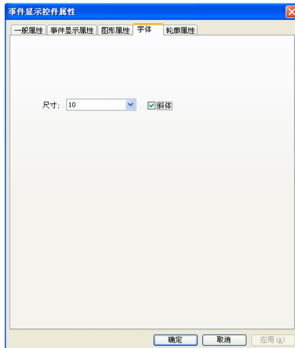
此时，只能设定“事件显示”控件中字体的大小和是否使用“斜体”效果。故障发生时，文字的字体，使用在“事件登录”时设定的字体。
