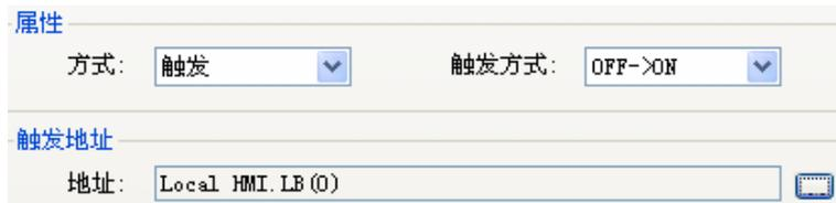
由上图的设置可以看出，当 Local HMI 中的 LB0 状态由 OFF 转为 ON 时执行“配方”数据的传输。
