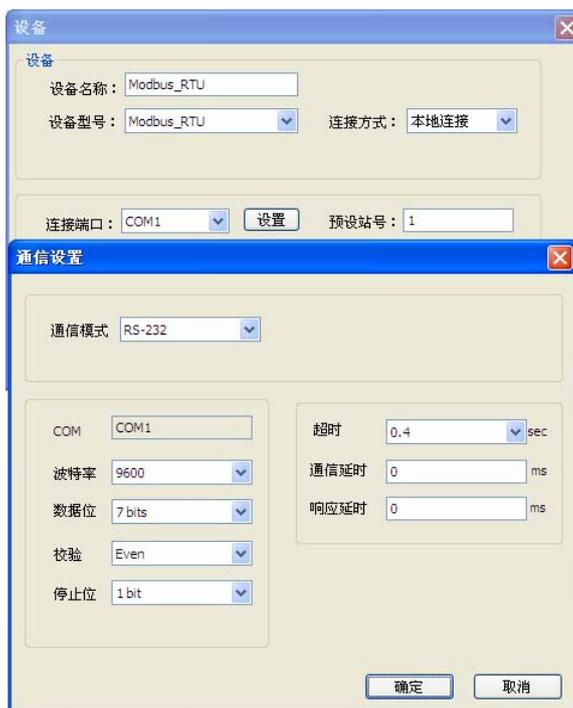
完成各项设定并按下“确定”键后，即可在设备列表中发现一个新的设备：“MODBUS\_RTU”。
