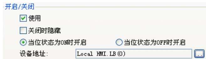
举例来说，假使某一个“位状态设定”控件使用安全属性中的“开启/关闭”功能，并且它的“开启/关闭”地址为[LBO]，并选择[当位状态为 ON 时开启]，则必须在[LBO]状态为 ON 时，才允许操作此控件，否则操作无效。“开启/关闭”提供下列的设定：
