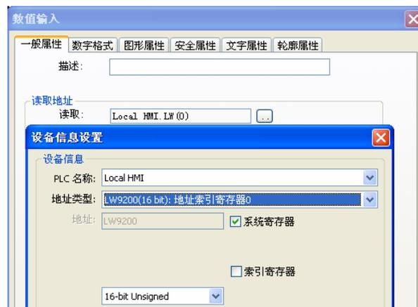
再建立两个“触发式资料传输”控件，一个“来源地址”选择为 Local HMI 的 RW0 开始的连续的 10 个寄存器，且勾选“索引寄存器”为“INDEX0”，“目标地址”为“汇川 H2U” PLC 的 D0 寄存器，目标地址不勾选“索引寄存器”，在该控件的“标签”中设置文字为“下载”。再建立另外的一个“触发式资料传输”控件，与刚刚设定的控件的“来源地址”和“目标地址”的设定颠倒一下，并在“标签”中设置文字内容为“上传”。两个控件的属性均设置为“手动”。建立后的图形见下图所示。
