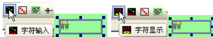
选择“字符输入”或“字符显示”双击或单击鼠标右键选择“属性”进行编辑。“字符输入”与“字符显示”控件属性对话框的差别，在于“字符输入”控件增加“通知”与“键盘输入功能的设定”项目。下图为“字符输入”控件的[一般属性]设定页。如下图：
