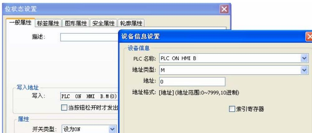
同样的，如果在 HMI A 上连接有一台或者多台 PLC，如果 HMI B 要访问 HMI A 上的这些 PLC，均是通过此种方法来连接，在此就不多做详述，使用者可以比照此设定来制作程序。
