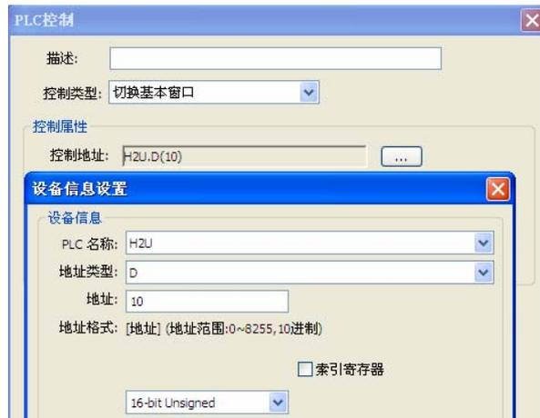
接下来，应该确定操作数据的大小和地址的偏移量，将 D11 设定为 16，表示传输数据的大小为 16 words；将 D12 设定为 86，表示数据的来源地址为 D100 (100 = 10+4+86)；将 D13 设定值为 200，表示目标地址为 RW200。
