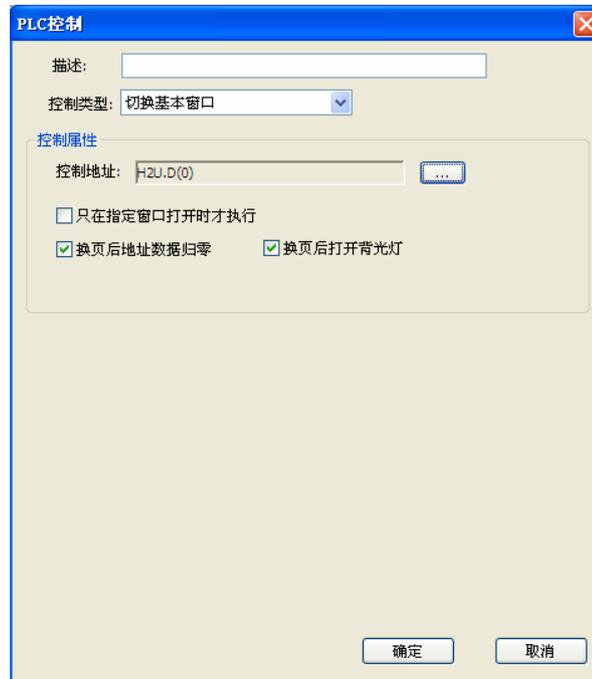
b) 设定由连接的哪个 PLC 来切换窗口，并在“触发地址”项的“设备类型”和“地址” 里面填上相应的设备类型和地址。并设定地址的数据格式。一般设置为 16-bit unsigned 格式。数据格式根据 PLC 中数据格式来设定。
