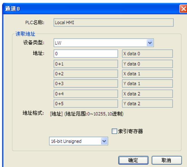
未勾选“X 轴数据与 Y 轴数据来自不同地址”, 但勾选了“上下限值取自寄存器”时, 按下设定键, 会显示该通道数据来源的设定对话框, 使用者可以设定设备类型及资料格式, 对话框右半部是显示各数据地址的含义, 包含 X 轴、Y 轴数据的最小值与最大值, 以及 X 轴、Y 轴坐标数据读取地址。如下图中右边的文字说明。
