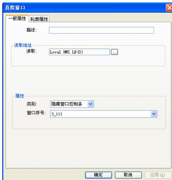
3) 选择“读取地址”， PLC 中需要控制直接窗口弹出的“设备类型”和“地址”。
