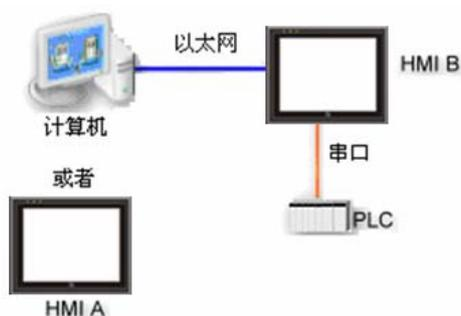
透过以太网，计算机与 HMI 可以操作连接在其它 HMI 上的 PLC；举例来说，假设现有一台汇川 PLC 连接到 HMI B 的 COM 1 口，当计算机或 HMI A 欲读取此台 PLC 上的数据，则计算机端或 HMI A 上所使用工程文件设定步骤如下：
