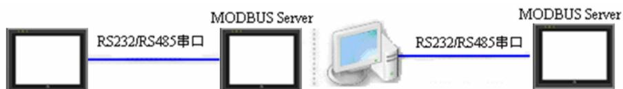
上图显示 InoTouch 被设定成 MODBUS 从站(又称为 MODBUS Server), InoTouch 人机界面、计算机或其它设备只需使用 MODBUS 协议，使用 RS232/485 串口，即可读写 InoTouch 上的数据。下面将说明如何将 InoTouch 设定成 MODBUS 从站，并说明读写 InoTouch 数据的方式。
