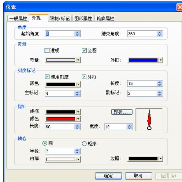
上图的设定对话框用来设定“表针”控件的外观，各部分的名称可以参考下图。
