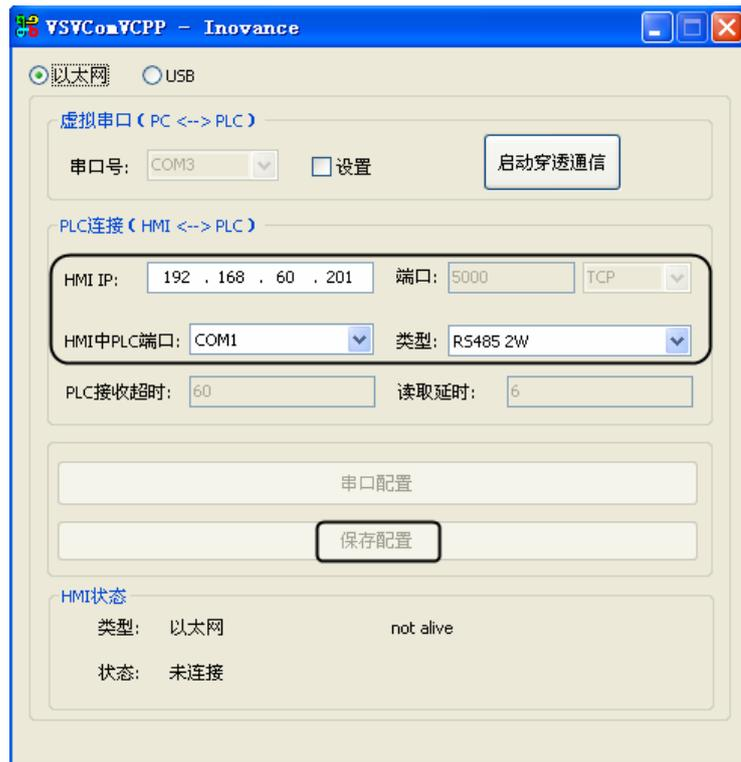
正常连接 HMI 后，PLC 后台可以使用启动的串口设备，直接与 PLC 通信。
