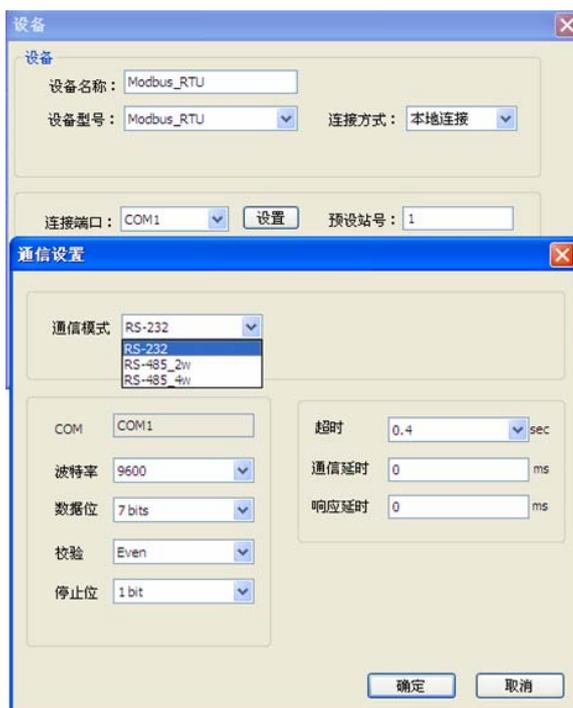
当接口挑选使用 RS232 或 RS485 时，需选择使用的连接端口(COM 1 ~COM 3)，并设定正确的通讯参数，参考下图，此时 MODBUS Server 的站号设定为 1。
