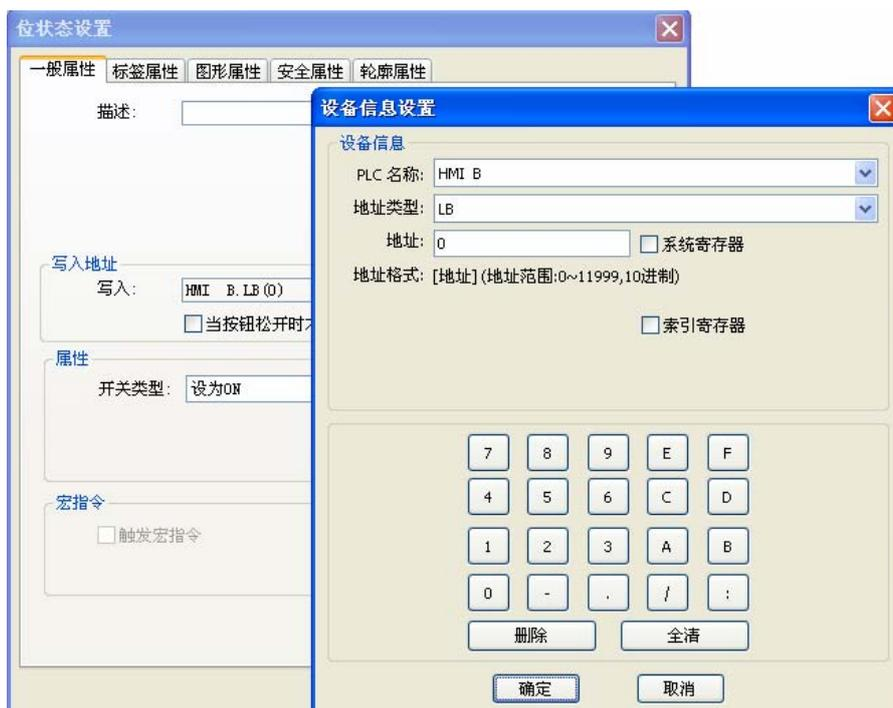
同样的，在 HMI B 中也可以建立一个远程的 HMI，将 IP 地址设置为 HMI A 的 IP 地址和端口号，这样，在 HMI B 上，也可以控制 HMI A 上的地址和数据了。
