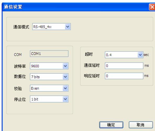
从以上图片可以看出，通讯参数是 9600 波特率、7 位数据位、1 位停止位、偶检验，使用的是人机界面的 COM1 RS485 4W 的方式连接到汇川 PLC。
