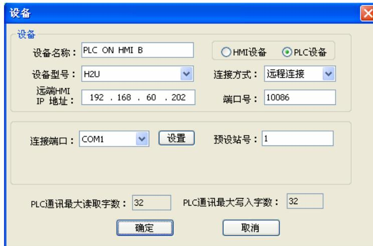
由上图可以发现，此时新增的 PLC 的所在位置为“远端”。因此台远程 PLC 是连接在 HMI B 上，所以设定的 IP 为 HMI B 的 IP (192.168.60.202)。
