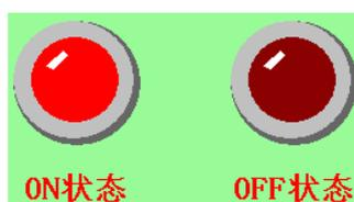
打开 InoTouch Editor 软件菜单的“控件/状态指示灯/位状态指示灯”，或者工具栏上的图标
