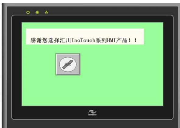
f、此时，再按一次“位状态切换开关”控件，将会把 11 号窗口关闭，在“直接窗口”原件的位置上消失。如下图所示。
