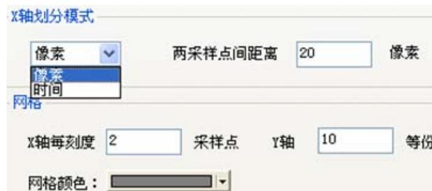
当选择[像素]来设定取样点的描绘距离时，则此时用来选择每两个垂直网格线间将包含几个取样点。
