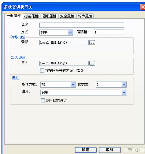
此图为上图结果中“多状态切换开关”控件的设定
