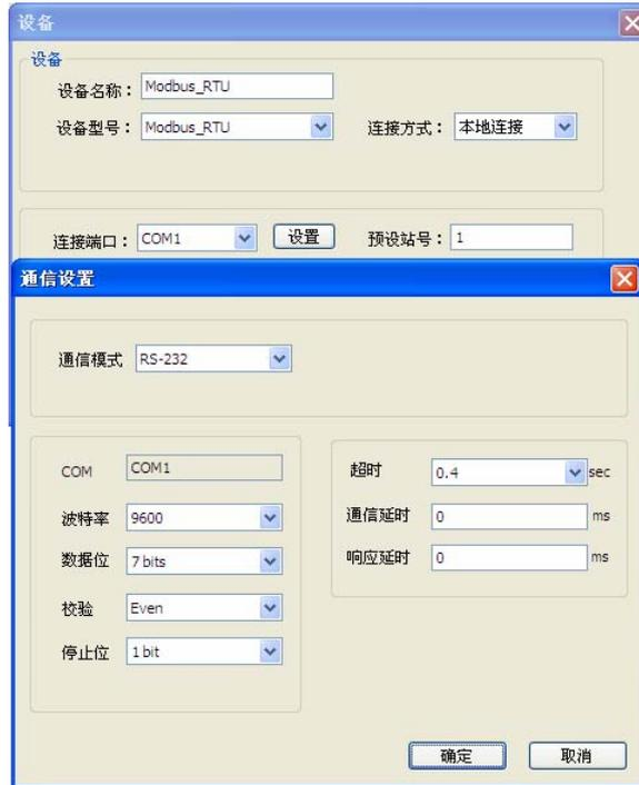
在按下“确定”键后，此时即完成了 MODBUS 设备的设定，在完成 afs 档案的编译并将获得的 EOH 档案下载到 HMI 后，即可透过 MODBUS 协议即可读写 InoTouch 上的数据。
