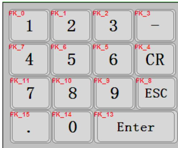
在完成上述的所有步骤后，当使用者使用“数值输入”或“字符输入”控件的设定页时，即可发现在[键盘]设定项目的[窗口编号]中，增加了“Keyboard”的选项，如下图所示。下图的[键盘弹出位置]被用来选择键盘的出现位置，InoTouch Editor 将屏幕分为 9 个区域，键盘的左上角将出现在所挑选区域的左上角位置。
