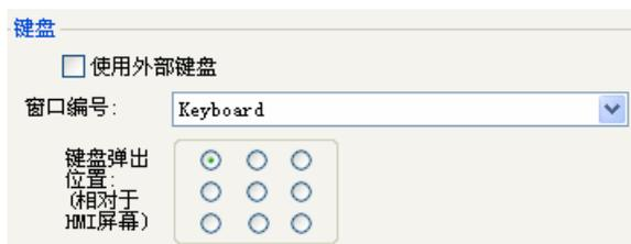
在选择“Keyboard”后，当使用者按下“数值输入”或“字符输入”控件时，InoTouch Editor 画面中选定“窗口 100”作为输入键盘的控件，将自动弹出“窗口 100”，按下“窗口 100”上的“功能键”控件将等同键盘输入讯号，如下图所示。
