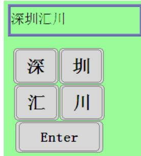
小结：数字键盘和字符键盘均是通过使用“功能键”控件制作，并组合在一起形成的。并可以将自制的键盘群组为“群组图片”添加到“群组图库”中，以便于后续的调用。如果不使用系统预设的键盘，可以将自制的键盘，作为新增的系统键盘。如果在做“数值输入”或者“字符输入”时，不想使用系统键盘，则需在这些控件属性中勾选“使用外部键盘”，这样就可以使用其他方式的键盘，包括外接的 USB 键盘。
