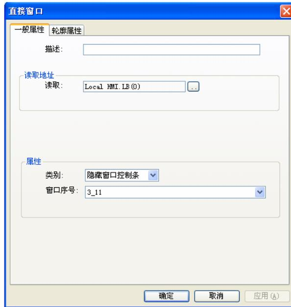
b、由上图可以看出，是使用 LB0 这个位来控制窗口 11 的显示和关闭。且隐藏了窗口控制条。这样，再做一个“位状态切换开关”控件，读取地址和写入地址均设定为 LB0，“开关类型”设置为“切换开关”。并将状态 0 的文字标签设置为“开启”，状态 1 的文字标签设置为“关闭”，如下图所示。
