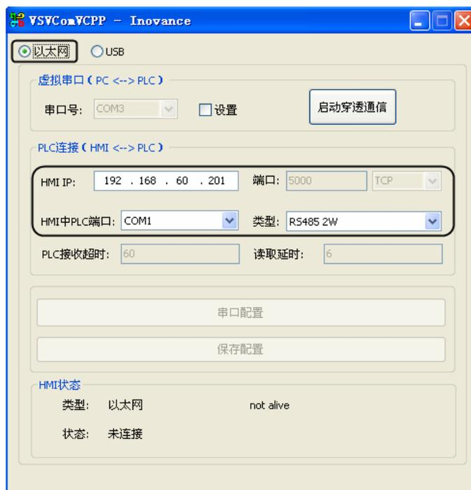
步骤 3: 点击“启动穿透通信”，开始进行通讯。穿透工具里的 COM 口号与 PLC 通讯的 COM 口号要一致。
