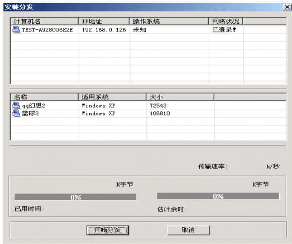
进入升级分发界面，被分发的计算机会重起变为开放模式，并自动登陆。同时接收端的计算机的鼠标和键盘被锁定。
