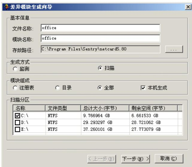
在模块组成中选择需要扫描的内容，选择「注册表」则只对注册表信息进行扫描，选择「目录」只对选定的扫描分区中的目录进行扫描，选择「全部」则不仅对扫描分区中的目录进行扫描同时对注册表进行扫描；选择「本机生成」则不在差异模块中保存数据的实体，模块不具有可移植性，但无需追加数据，生成模块速度快，不选择本机生成则生成的差异模块中保存数据实体，模块具有可移植性，可将生成的模块拷贝到管理端进行增量拷贝。
