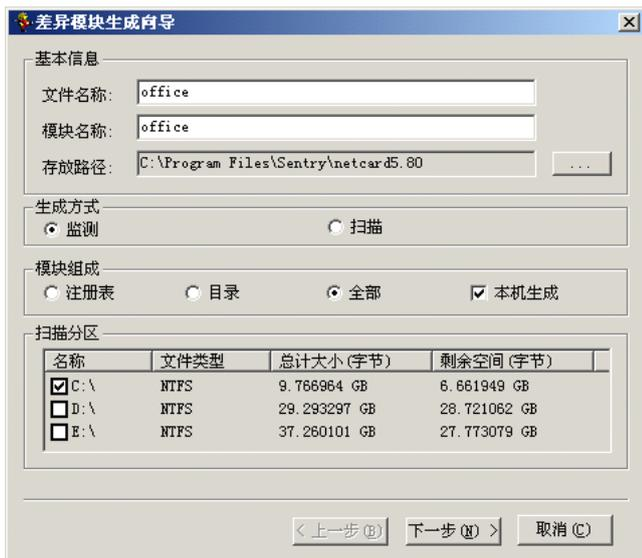
在模块组成中选择需要监测的内容，选择「注册表」则只对注册表信息进行监测，选择「目录」将对硬盘所有分区中的目录进行监测，选择「全部」则不仅对分区中的目录进行监测同时对注册表进行监测；选择「本机生成」则不在差异模块中保存数据的实体，模块不具有可移植性，但无需追加数据，生成模块速度快，不选择本机生成则生成的差异模块中保存数据实体，模块具有可移植性，可将生成的模块拷贝到管理端进行增量拷贝。
