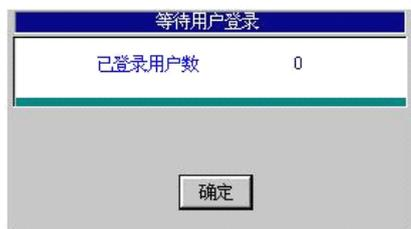
9、对于网络拷贝接收端，用 Tab 键或上下箭头键将光标移到网络拷贝接收端选项，按一下 ENTER 键，网络拷贝接收端即开始登录。
