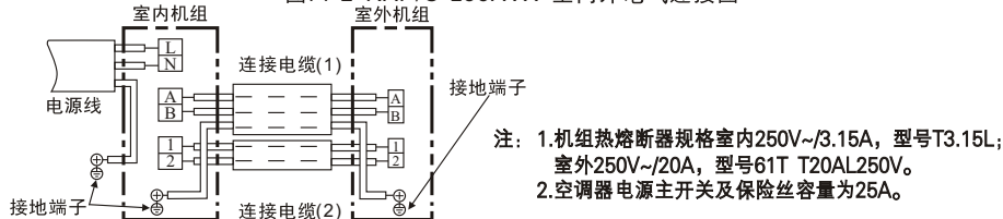
图14-2 RAP/C-L53AVX 室内外电气连接图
