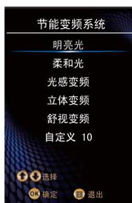
2. **节能**：按该键显示节能变频系统菜单，您可以根据需要按▲/▼键选择明亮光-柔和光-光感变频-立体变频-舒视变频-自定义中的任一种模式，选择自定义时您可以根据自己的需要调整液晶背光亮度，以达到满意的显示效果。
