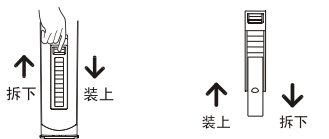
拆装线屑过滤器
