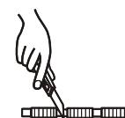
5. 加长排水管过长时，可从A或B两处切除排水管。
