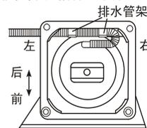
3. 将排水管从排水阀上拆下(注意不要弄破排水管)将弯头方向转180°, 在排水阀连接处涂上801胶, 然后把排水管装上, 并用管卡卡牢固, 再把排水管从箱体右侧安装孔伸出, 并用排水管架固定在箱体上, 最后把排水管挂在箱体挂耳上。
