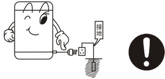
洗衣机安装就位及正常使用时，电源线插头应便于用手插拔，停电、移动、不用或清理时，一定要把电源插头拔下并关掉水龙头，请勿用潮湿的手去插或拔插头。
