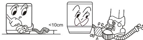
4. 需加长排水管时，请另购排水管，加长排水管的内径应不小于 30mm，长度应不大于 1.5m。
