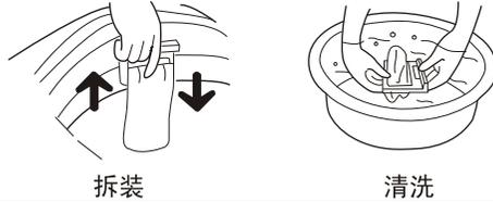
进水阀的过滤网易被杂物堵塞，阻碍进水，应大约每两个月用刷子清扫一次。
