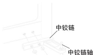
3. 将右上铰链轴拆下，安装到左边相应的位置上；将箱体中梁处左侧的螺钉塞和冷冻门体左侧的孔塞拆下；将冷藏门体右侧止档安装到冷冻门体左侧，将冷冻门体右侧止档安装到冷藏门体左侧相应位置上；
