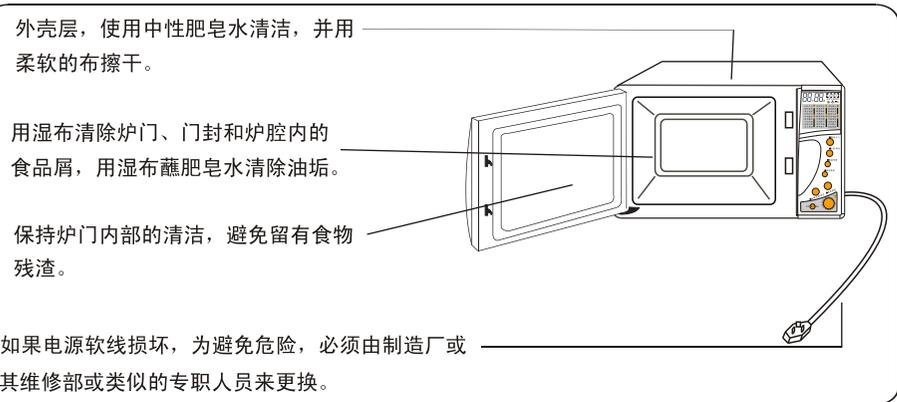
注：微波炉长期不用时，注意将炉体各部位可能残留的水渍、油垢擦干净，避免生锈。
