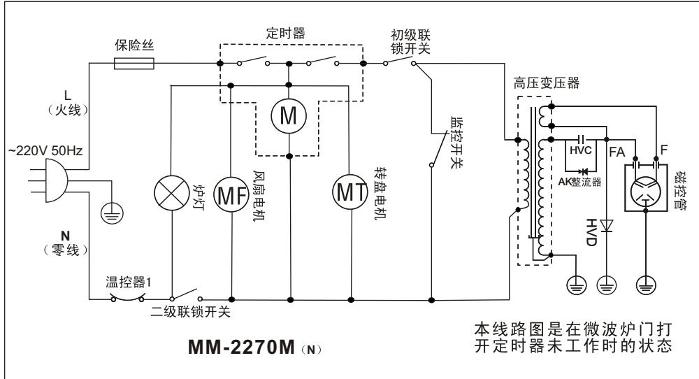
本线路图是在微波炉门打开定时器未工作时的状态
