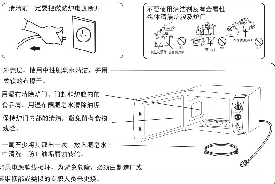
注：微波炉长期不用时，注意将炉体各部位可能残留的水渍、油垢擦干净，避免生锈。
