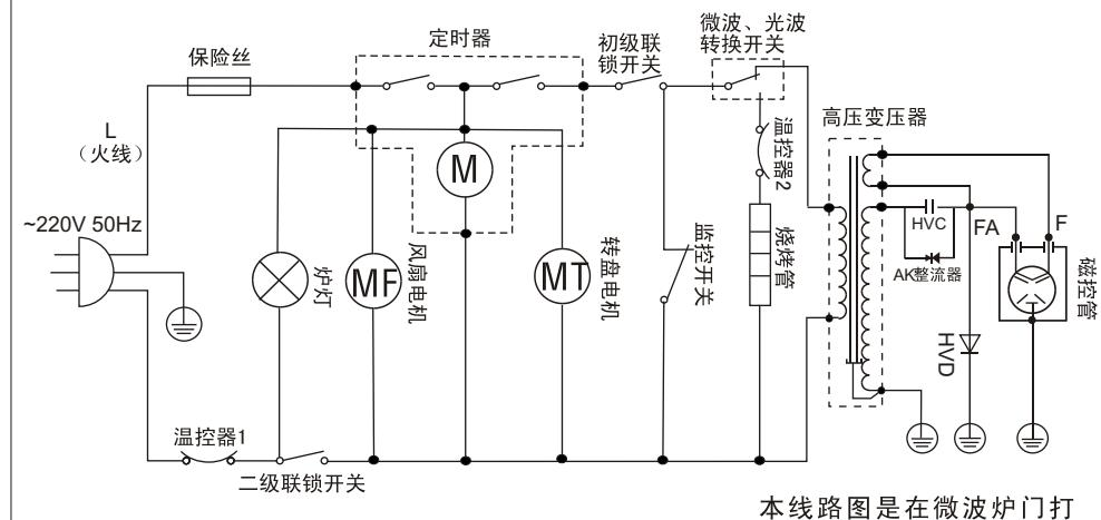
本线路图是在微波炉门打开定时器未工作时的状态
