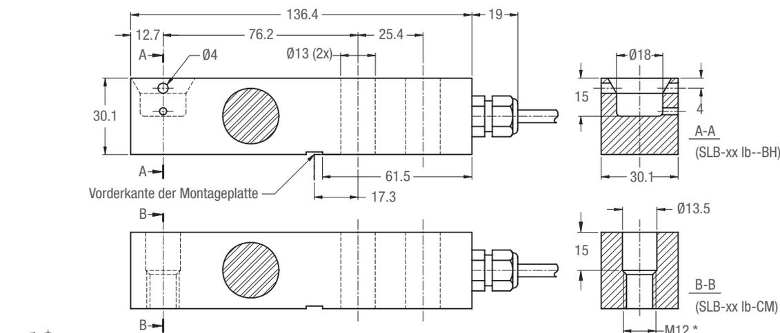
Montageschrauben für 200 lb bis 2 500 lb: M12 8.8 / Anzugsmoment 90 Nm; für 5 000 lb: M12 10.9 / Anzugsmoment 120 Nm. Schraubengewinde zur Montage fetten.
