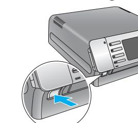
2 如下所示，使用提供的USB电缆连接扫描仪到打印机。
