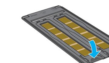
7 在支架插槽中插入35毫米支架。当支架到达一定位置时，可以自动进入到需要的位置。
