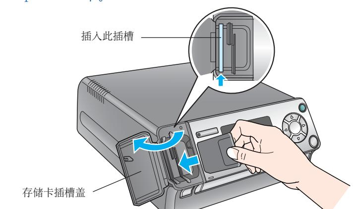
3 关闭存储卡插槽盖。
