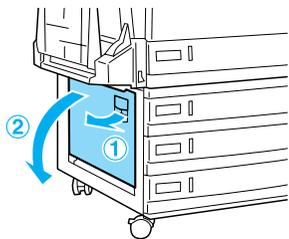
如果发现夹纸，按夹纸 E 中的步骤 2，用手拿住纸张的末端来取出夹纸。夹纸取出后，继续第 5 步。
