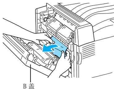
如果被夾的紙張沒有夾在出紙槽處，打開 B 蓋取出夾住的打印紙
