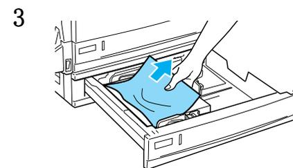
如果发现夹纸, 按夹纸 E 中的步骤 2, 用手拿住纸张的末端来取出夹纸。夹纸取出后, 继续第 5 步。
