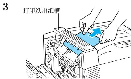
如果被夾紙張的末端在出紙槽處夾紙，輕輕的從紙槽中取出夾住的打印紙，然後繼續第 5 步。
