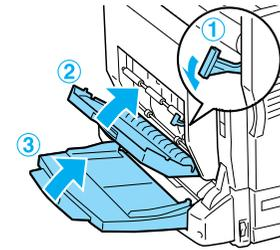
如果打印纸的末端看得见，按夹纸 B 中的步骤 2，用手拿住纸张的末端取出夹纸。
