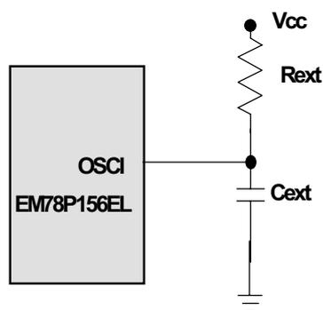
图15 外部振荡器模式下的电路
