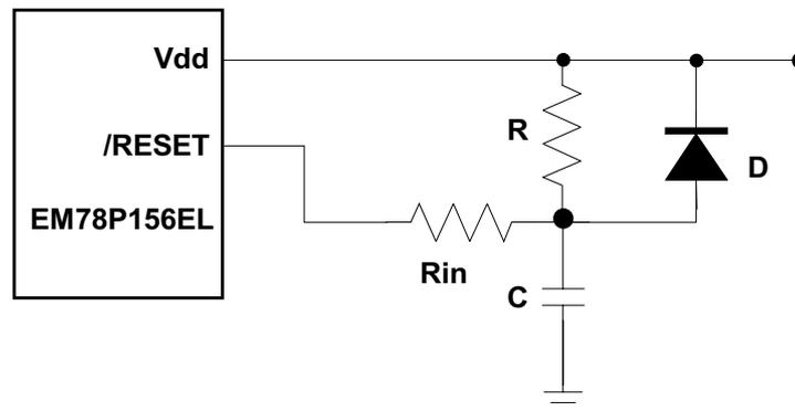
图16 外部上电复位电路
