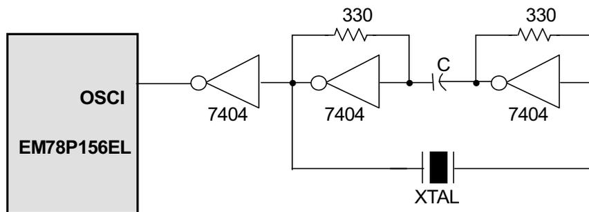
图13 晶振/谐振器串联电路
