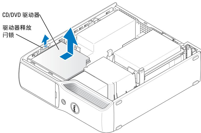
5 从驱动器的背面断开电源电缆和 CD/DVD 驱动器电缆的连接。
