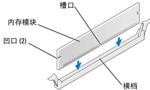
**注意：**为避免损坏内存模块，请在模块两端均匀用力，将其竖直向下按入连接器。
