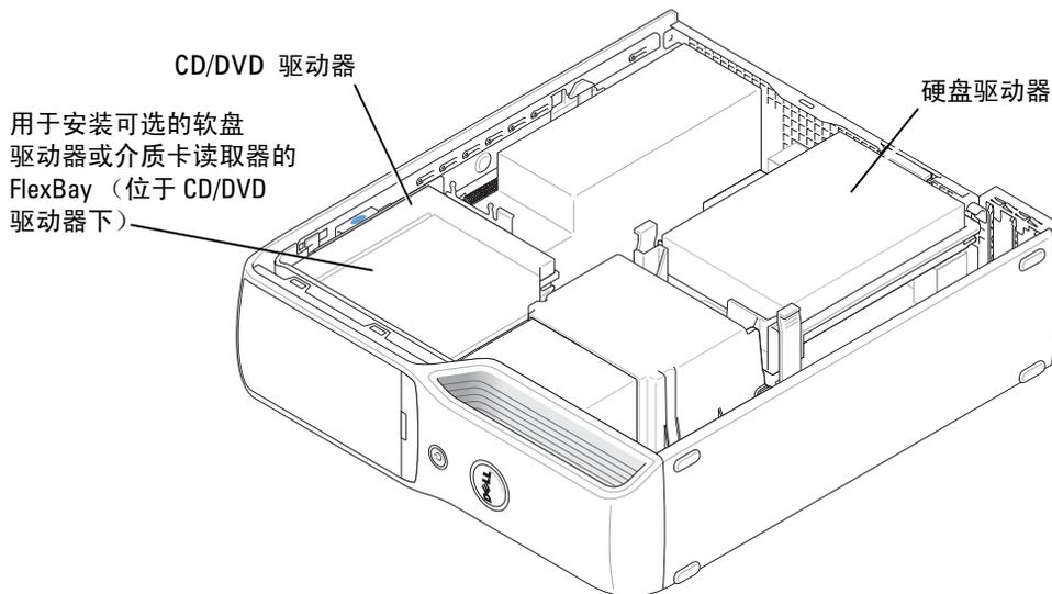
将 CD/DVD 驱动器连接至系统板上标有“IDE”的连接器的。串行 ATA 硬盘驱动器应连接至系统板上标有“SATA0”或“SATA2”的连接器的。
