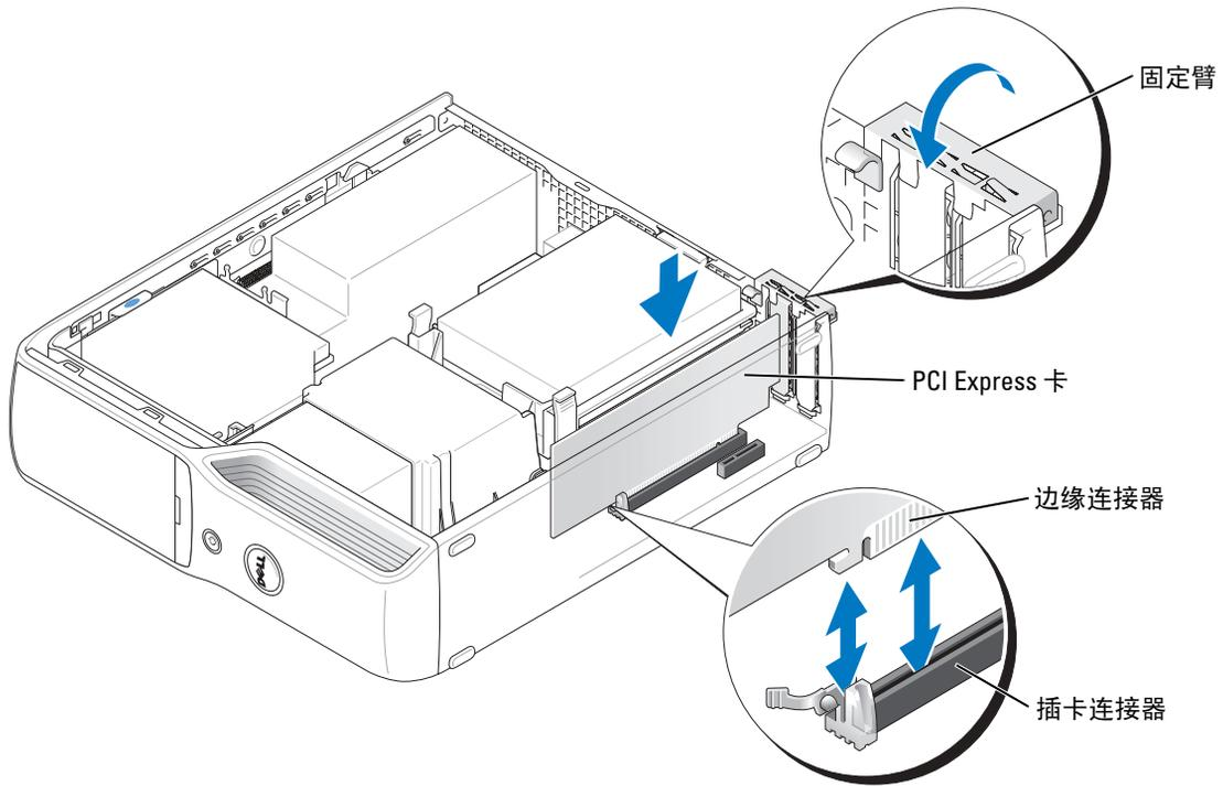
**注意：**请勿将插卡电缆放在插卡的上面或后面。将电缆放在插卡上会妨碍主机盖的正确闭合或损坏设备。
