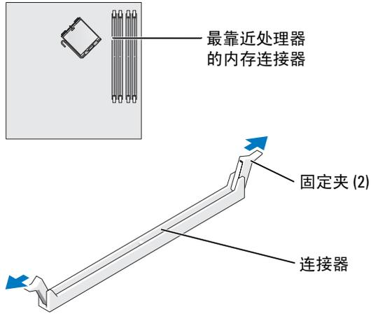
4 将模块底部的槽口与连接器中的横档对齐。
