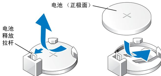
**注意：**为避免损坏电池连接器，在安装或卸下电池时，您必须牢固地撑起连接器。
