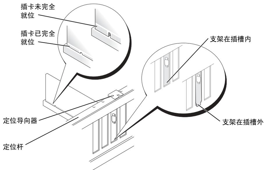
9 如果您更换了计算机中已安装的插卡，并且卸下了固位机件，则请重新安装固位机件。
