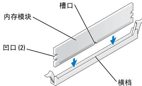
**注意：** 为避免损坏内存模块，请在模块两端均匀用力，将其垂直向下按入连接器。
