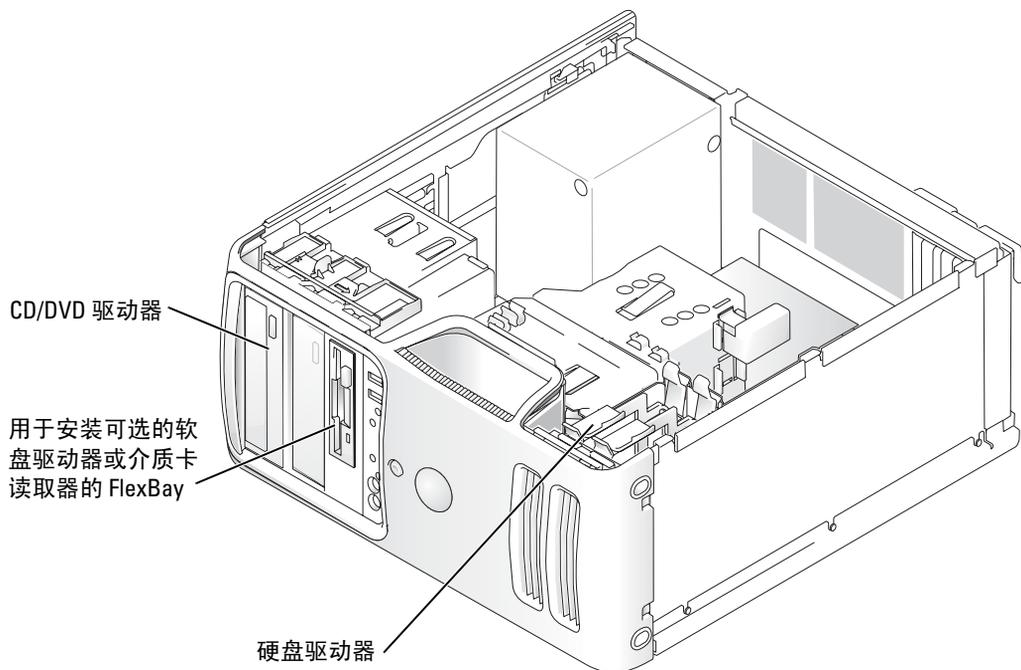
将 CD/DVD 驱动器连接至系统板上标有“IDE1”的连接器。串行 ATA 硬盘驱动器应连接至系统板上标有“SATA0”或“SATA2”的连接器。
