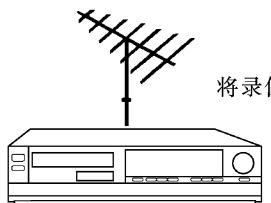
将录像机(或影碟机)的射频输出端子与电视机的天线输入端子连接。
