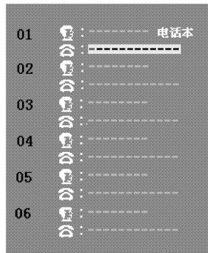
“-”表示未命名的字符,红色表示当前输入字符的位置,输入字符 2 秒后自动移到下一个位置;节目+/-键垂直方向移动编辑位置;音量+键水平向右移动编辑位置,音量-键水平向左移动编辑位置且删除目标位置字符。
