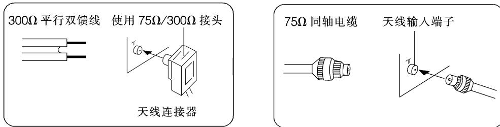
注:① 建议您最好使用  $75\Omega$  同轴电缆，以消除因阻抗不匹配导致的杂波和干扰。
