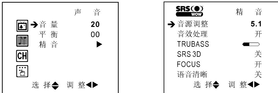
直接按精音键或在声音菜单中选择“精音”项,再按音量+/-键均可进入精音菜单。
