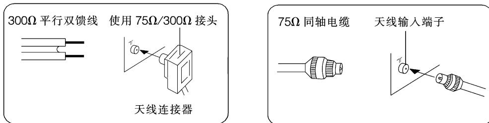
注:① 建议您最好使用  $75\Omega$  同轴电缆,以消除因阻抗不匹配导致的杂波和干扰。
