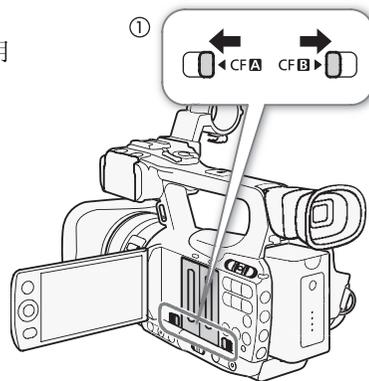
2 将 CF 卡竖直地完全插入插槽，标签背向镜头，直到咔哒一声安装到位为止 ( 2)。
