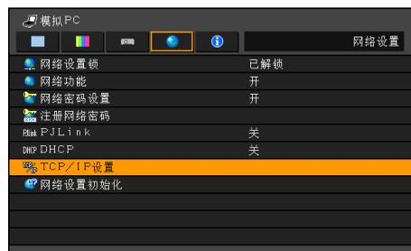
选择 [TCP/IP 设置] 时，会出现以下窗口。用 [▲]/[▼] 按钮选择 IP 地址，然后按 确认 按钮。然后，用 [◀] 和 [▶] 按钮选择数字以及用 [▲]/[▼] 按钮更改数值。按下 确认 按钮，然后以同样的方式设置子网掩码和网关地址。最后，选择 [确认]。
