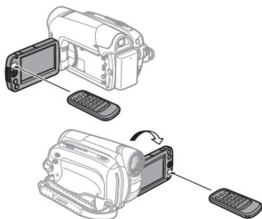
按遥控器的按钮时，把遥控器对准摄像机的遥控感应器。
