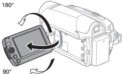
您可将液晶显示屏向镜头方向旋转 180 度（在您使用取景器时，可使被摄者监视液晶显示屏）。这是您同时使用取景器和液晶显示屏的唯一情形。在下列情况下，将液晶显示屏旋转 180 度十分有用：
