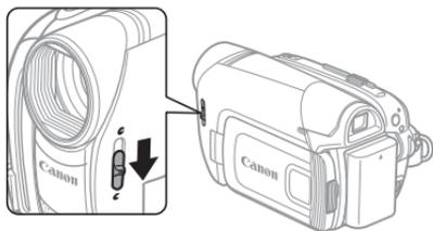
将镜头盖开关下移至⊖以打开镜头盖。
