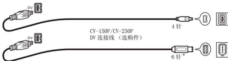
\* 请小心正确地将 6 针插头插入 DV 端子。插入方向错误会损坏摄像机。
