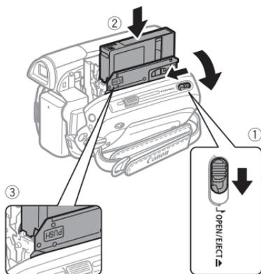
1 按箭头方向推移 **OPEN/EJECT** 至尽头，然后打开磁带仓盖。
