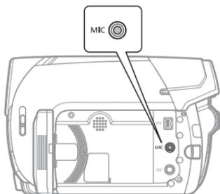
将外接麦克风连接至 MIC 端子。使用自带电源且连接线长度不超过 3 米市面有售的电容式麦克风。几乎可连接所有带有直径为 3.5 mm 插头的立体声麦克风，但音频记录电平可能有所不同。
