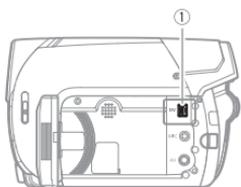
打开液晶显示屏面板进行连接。
