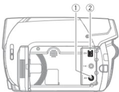
打开液晶显示屏面板进行连接。
