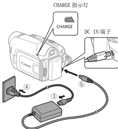
3 连接电源线至小型电源转接器。
