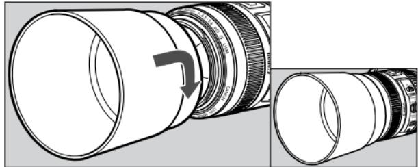
遮光罩 ET-65B 能够阻挡不必要的光线进入镜头，并能保护镜头，使其避免受到雨、雪和灰尘的侵扰。
