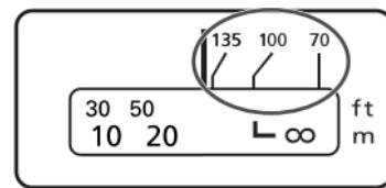
用于补偿由于温度变化而导致无限远对焦点的偏移。
