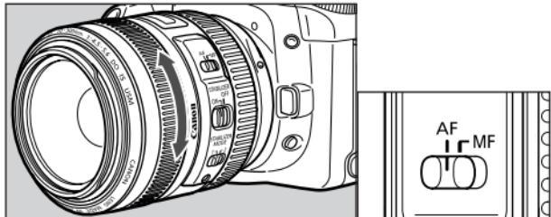
要在自动对焦模式( AF )下进行拍摄，请将对焦模式开关设置为 AF 。
