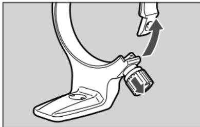
**1** 逆时针旋转锁定旋钮至松懈（转3圈），然后按箭头方向拉旋钮以使环打开。
