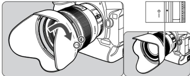
遮光罩 EW-83K 能够阻挡不必要的光线进入镜头，并能保护镜头，使其避免受到雨、雪和灰尘的侵扰。安装遮光罩时，将遮光罩的安装位置标记对准镜头前部的红色圆点，然后按箭头所示的方向转动遮光罩，直至镜头的红色圆点与遮光罩停止位置标记排成一线。
