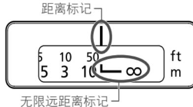
用于补偿由于温度变化而导致无限远对焦点的偏移。
