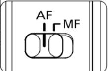
要在自动对焦模式 (AF) 下进行拍摄，请将对焦模式开关设置为 AF。
