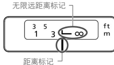
用于补偿由于温度变化而导致无限远对焦点的偏移。
