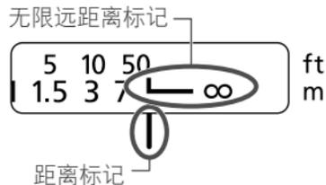
用于补偿由于温度变化而导致无限远对焦点的偏移。L 标记垂直线和距离刻度上的距离指示标记对齐的一点就是常温下的无限远位置。
