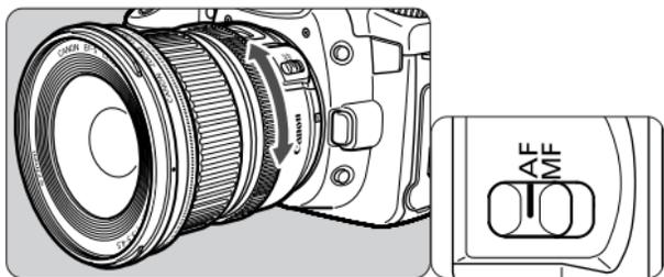
要在自动对焦模式 ( AF ) 下进行拍摄，请将对焦模式开关设置为 AF。
