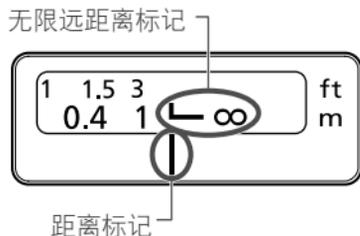
用于补偿由于温度变化而导致无限远对焦点的偏移。L 标记垂直线和距离刻度上的距离指示标记对齐的一点就是常温下的无限远位置。
