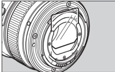
在镜头后部有一个明胶滤光镜架。请准确切割明胶滤光镜，使其处于白色框架以内。然后将明胶滤光镜插入滤光镜架。
