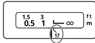
使用黑白红外胶片拍摄时，红外指示标记用于更正对焦设置。对主体进行手动对焦后，转动对焦环至对应的红外指示标记来调整距离设置。
