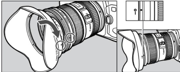
遮光罩EW-83E能够阻挡不必要的光线进入镜头，并能保护镜头，使其避免受到雨、雪和灰尘的侵扰。安装遮光罩时，将遮光罩的安装位置标记对准镜头前部的红色圆点，然后按箭头所示的方向转动遮光罩，直至镜头的红色圆点与遮光罩停止位置标记排成一线。
