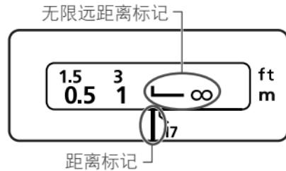
用于补偿由于温度变化而导致无限远对焦点的偏移。
