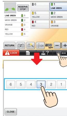
Berühren Sie die Taste für die Nadelstange, in die der Faden eingefädelt werden soll.
