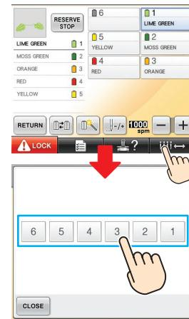
Berühren Sie die Taste für die Nadelstange, in die der Faden eingefädeln werden soll.
