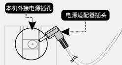
将电源适配器插头一头插入电源插座, 另一头插入本机“外接电源插孔”。
