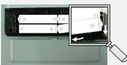
如图所示, 将电池仓盖向下推动, 然后取出电池仓盖。按电池“+、-”标识正确装入4节7号(AAA)电池, 电池装好后合上电池仓盖。
