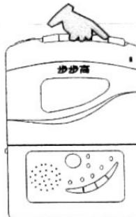
B. 在磁带放音状态下，按住放音 / 自动键 2 秒，即进入自动复读状态。
