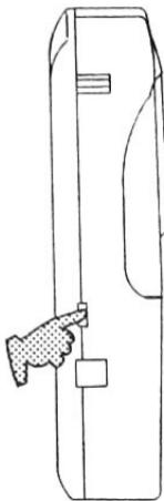
BK-785型具有290秒高保真复读和450秒普通复读相互切换功能，只需扳动左侧的“复读时间切换开关”即可。BK-781型则具有100秒高保真复读和200秒普通复读相互切换功能。
