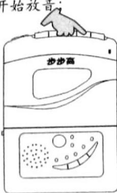
B. 按一下跟读 / 对比键，录入子音后，再按一下跟读 / 对比键，复读机开始播放母音和您所录入的第一次子音；之后，只需反复按跟读 / 对比键，反复录入子音即可。
