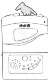
B. 在磁带放音状态下，按一下复读键，即可反复复读刚播放的内容；
