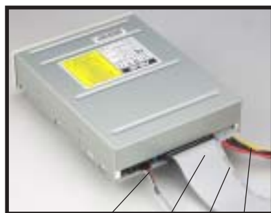
CD-ROM 音源线 IDE 排线 红色端为第一脚位 电源线(P1)
