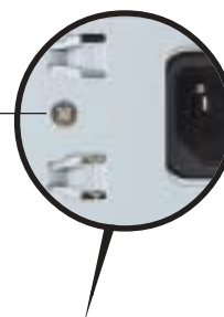
电源插座模块上的电源及电压调整插座
